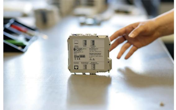
Der Ethernetanschluss ermöglicht einen direkten Anschluss an einen PC, alternativ auch über einen Knotenpunkt wie Hub oder Switch. Messwerte können zudem über Modbus TCP abgerufen werden. Die Kommunikation über Modbus RTU ermöglicht außerdem ein Zusammeschalten von bis zu 32 Teilnehmern.
